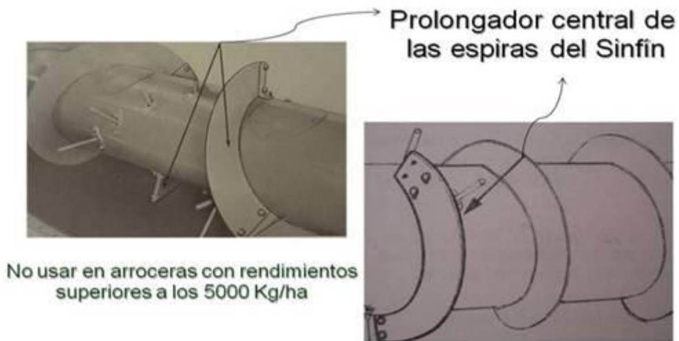
Figura 12. Prolongador central de las espiras del sinfín.
