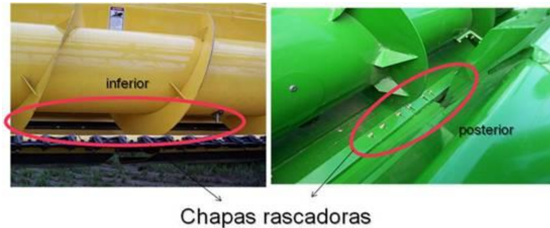
Figura 10. Chapa rascadora inferior y posterior, fragmentada y con registro de regulación.
