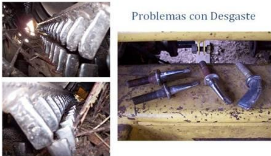
Figura 16. Desgaste excesivo de los dientes del cilindro-cóncavo arrocero.
