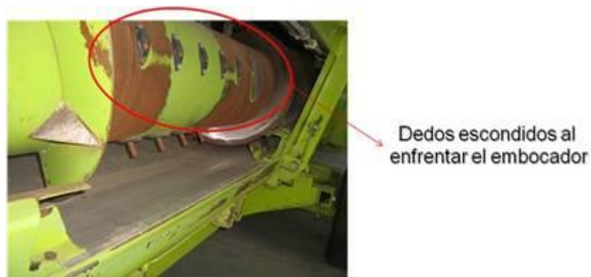
Figura 8. Regulación correcta de los dedos retráctiles centrales, escondidos al enfrenar el embocador.
