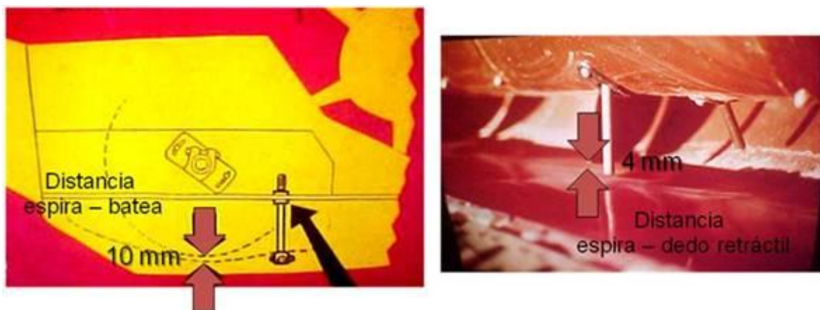
Figura 9. Regulación de espira y dedo retráctil de sinfín.
